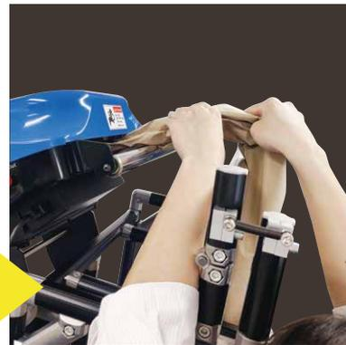
ロールペーパーをセット・・・ペーパーを引き出しテンションバーを通して・・・投入口にセットして完了！
